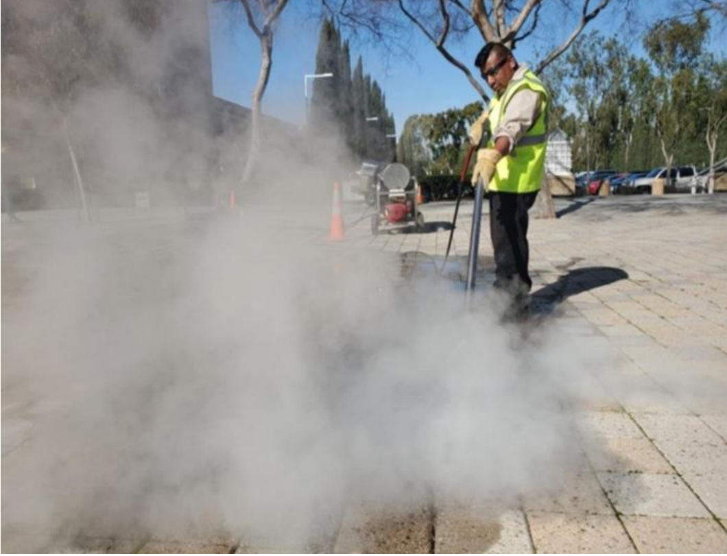
Sert zeminlerde otları temizlemek için buhar makinesi kullanılıyor.
